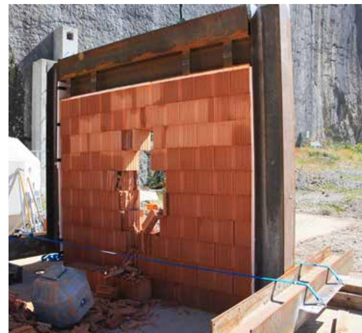
Étude de la vulnérabilité à l'impact d'un mur en maçonnerie.
