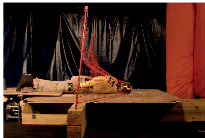
Evaluation du couplage d'un matelas et d'un filet dans un essai « crash test ». © Laboratoire de Biomécanique Appliquée
